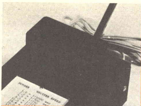
Fig. 4 - Particolari del blocco di montaggio della macchina fotografica. I due dispositivi fotosensibili (Q2 e LDR1) sono sistemati vicini alla superficie superiore del blocco.
